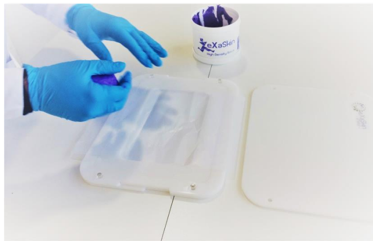
Fig. 1. iMold L con el marco interno colocado para preparar una lámina 17x11x0.5cm.
