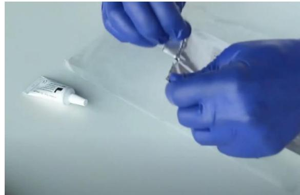
3. Extraiga la pasta (Componente A) y colóquela en el papel parafinado. Abra el tubo (Componente B) y coloque el catalizador (la pasta de color rojo) en la pasta. **ASEGURESE DE EXTRAER TODO EL CATALIZADOR DEL TUBO.**
